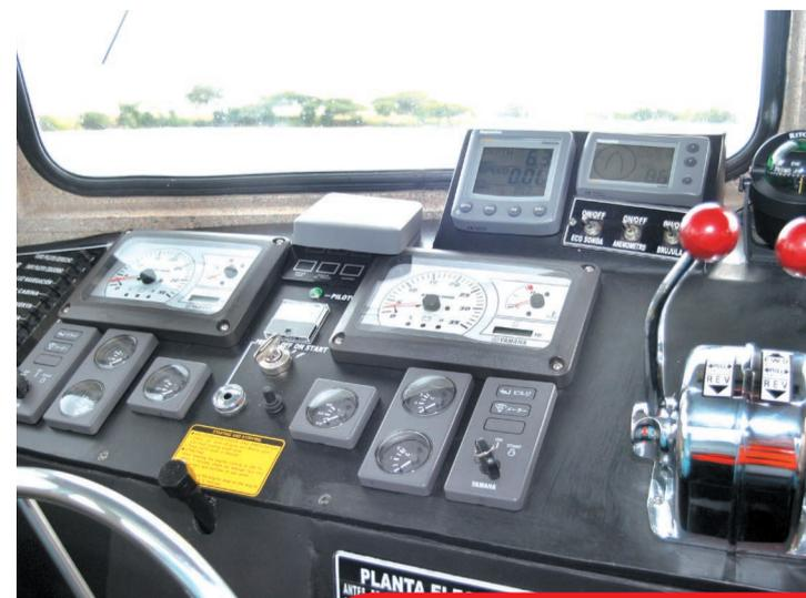
Las embarcaciones repotenciadas fueron dotadas de motores, sistema eléctrico tecnificado, indicadores del funcionamiento, sistema GPS, anemómetros, radar, luces, entre otros sistemas y equipos con los que se logró su modernización.
